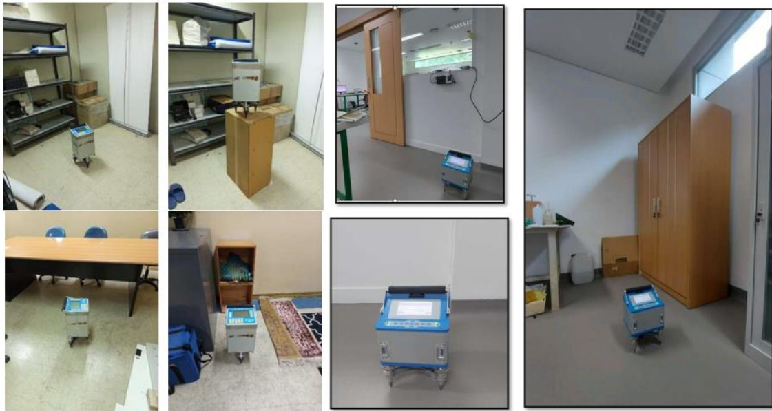
Gambar 22. Pengukuran nilai g lokal di laboratorium kalibrasi
